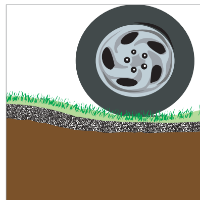
Superficie a prato non armato
