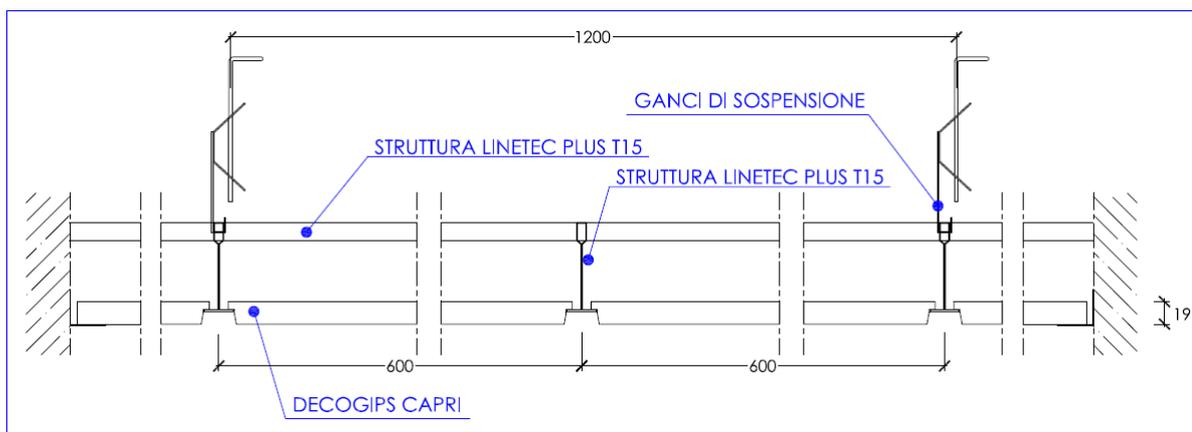
Controsoffitto modulare ispezionabile in pannelli di gesso alleggerito DECOGIPS CAPRI di dimensioni 600X600 mm costituito dagli elementi sottoelencati:
