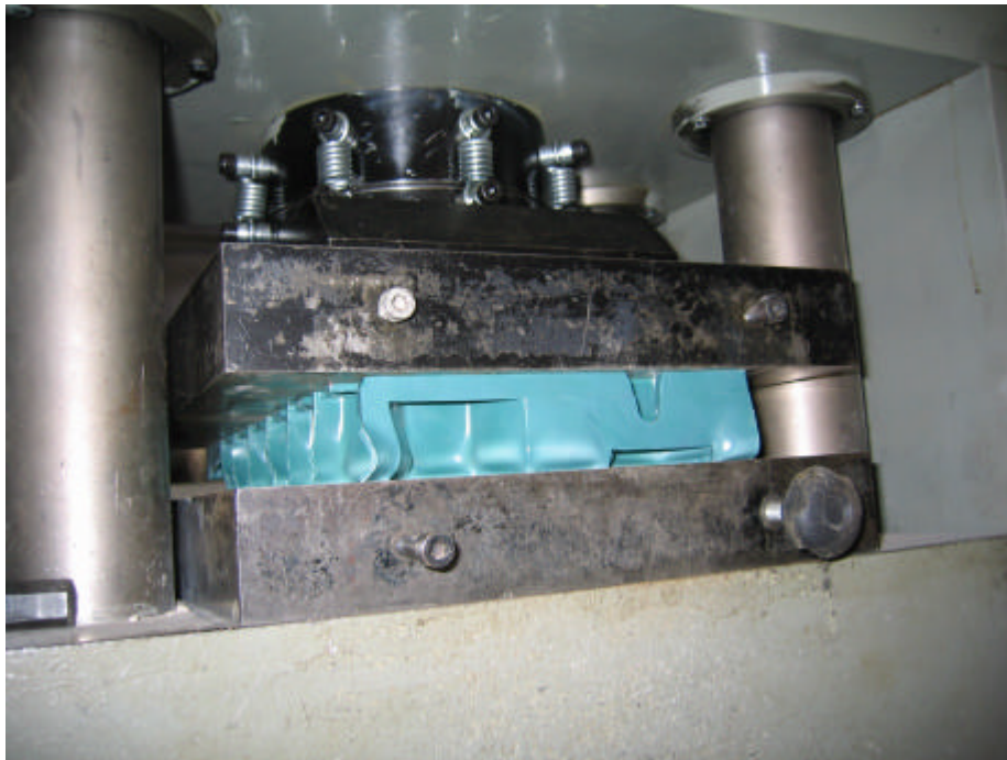
Particolare del campione durante la prova di compressione.
